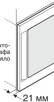
5. Затем закрепите прибор винтами для стружечных плит 3,5 x 17 через верхний уголок.
